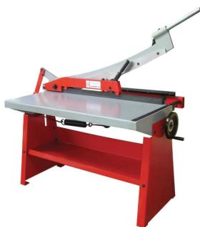
Die Holzmann BSS1000P Blechschlagschere ist ideal für die Bearbeitung von Blechen. Sie verfügt über einen großen Aufnahmetisch zur einfachen Beladung und Arretierung des Bleches. Der Breitenanschlag ist bis 600mm einstellbar. Die Schere ist mit einem Messer aus hochwertigem Qualitätsstahl ausgestattet und verfügt über eine Federunterstützung für den Rückzug des Schneidarmes. Die Holzmann BSS1000P ist inklusive Untergestell und Exzenterspanner.
