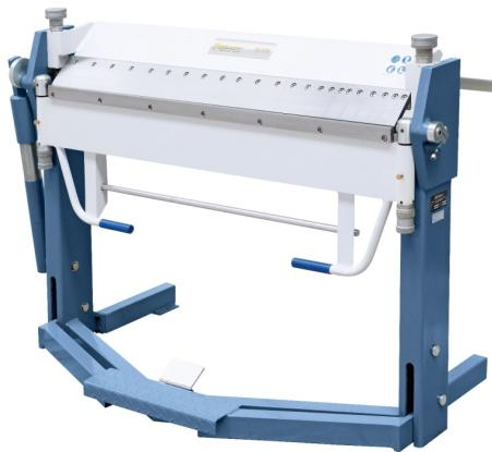
Die Bernardo TB 1270 Schwenkbiegemaschinen mit segmentierter Oberwange ist eine universell einsetzbare Biegemaschine für Spenglereien und Reparaturbetriebe. Sie bietet eine robuste Bauweise im modernen Design und ermöglicht eine leichte Verstellung der Oberwange mittels Fußpedal, wodurch die Hände frei für das Werkstück bleiben.
