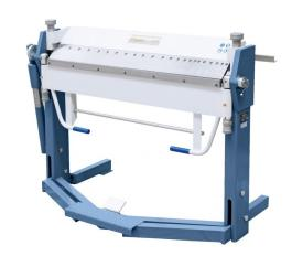
Die Bernardo TB 1270 Schwenkbiegemaschinen mit segmentierter Oberwange ist eine universell einsetzbare Biegemaschine für Spenglereien und Reparaturbetriebe. Sie bietet eine robuste Bauweise im modernen Design und ermöglicht eine leichte Verstellung der Oberwange mittels Fußpedal, wodurch die Hände frei für das Werkstück bleiben.
