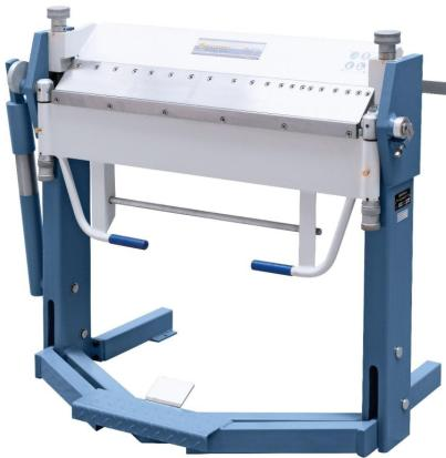
Die Bernardo TB 1020 Schwenkbiegemaschinen mit segmentierter Oberwange ist eine universell einsetzbare Biegemaschine für Spenglereien und Reparaturbetriebe. Sie bietet eine robuste Bauweise im modernen Design und ermöglicht eine leichte Verstellung der Oberwange mittels Fußpedal, wodurch die Hände frei für das Werkstück bleiben.
