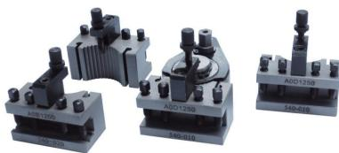
Das Produkt Holzmann SWHA System Multifix Größe A enthält verschiedene Teile mit unterschiedlichen Maßen. Es ist wichtig, dass der Aufnahmedorn angepasst wird. Die technischen Daten sind wie folgt:
