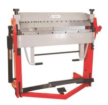
Die Holzmann AKM1020P Abkantmaschine bietet eine solide Konstruktion mit hochwertigen Abkantelementen für ein Höchstmaß an Präzision. Durch das einfache Öffnen der oberen Wange mittels Fußpedal und die verschiedenen breiten Abkantelemente für unterschiedliche Werkstückgrößen, bietet diese Maschine eine hohe Flexibilität. Die Abkantelemente sind beliebig verschieb- und zusammensetzbar, und die Blechdicke kann einfach über groß dimensionierte Justierschrauben eingestellt werden.
