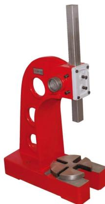
Die Holzmann DOP5000 Dornpresse ist ideal zum Einpressen von Lagern, Buchsen und anderen Fügearbeiten. Durch das hochwertige Graugussgestell können extrem hohe Presskräfte aufgebracht werden. Die Hebelkraftübertragung erfolgt durch eine großverzahnte Zahnrad-Zahnstangen-Kombination. Eine Universalgrundplatte ermöglicht eine flexible Verwendung.
