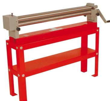
Die Holzmann BBM1000 Rollbiegemaschine ist ideal für die Bearbeitung von Blechen. Sie verfügt über ein gehärtetes Übersetzungsgetriebe für hohe Lebensdauer, ein komfortables Exzenterspannsystem und einfache Bedienung. Drei hochwertige Rundbiegerollen ermöglichen präzise Ergebnisse. Für konische Rundungen kann die hintere Rolle außermittig gestellt werden. Optional ist ein Unterbau erhältlich.
