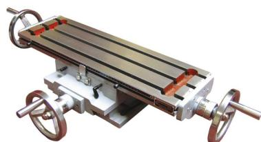
Der Holzmann ZX7025A Kreuztisch ist ein hochwertiges Werkzeug für verschiedene Anwendungen. Die Tischgröße beträgt 640x205mm, der Verfahrweg längs 380mm und der Verfahrweg quer 230mm. Die Verpackung hat die Maße 950x500x255mm und das Gewicht beträgt 65kg. Der Tisch verfügt über 14mm T-Nuten.
