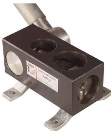
Die Holzmann RAM61 Rohrausklinkmaschine ist ideal für die Bearbeitung von Rohren mit einer Wandstärke bis zu 3mm. Der 910mm lange Abzugshebel mit Exzenterübersetzung ermöglicht eine effiziente Ausklinkung von Rohren. Die Maschine ist speziell geeignet für Gas-, Edelstahl-, NE- und Dampfrohre und kann für die Ausklinkung der Schweißlinie bei T- oder Doppeleckverbindungen verwendet werden.
