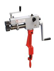
Die Holzmann SKM200 Sickenmaschine ist ideal zum Herstellen von verschiedenen Rohrverbindungen. Die Maschine verfügt über einen drehbaren Maschinenkörper und eine Tisch-Klemmvorrichtung. Mit den 6 unterschiedlichen Bördel- und Sickenwalzen können verschiedene Arbeiten durchgeführt werden. Die max. Arbeitstiefe beträgt 200mm und der Walzenabstand (Mitte-Mitte) 50mm.
