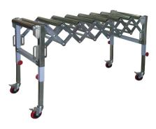
Die Holzmann RB9A Rollbahn ist eine ausziehbare Rollbahn mit 9 Rollen und einer maximalen Belastung von 130 kg. Sie ist höhenverstellbar von 600-1000 mm und fahrbar. Die Rollbahn ist erweiterbar durch Verbindungsmöglichkeit.
