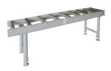
Die Holzmann RB9 Rollbahn ist eine hochwertige Lösung für den Transport von Gütern. Mit 9 Rollen und einer max. Belastung von 700kg ist sie ideal für den Einsatz in verschiedenen Branchen. Die Rollbahn ist höhenverstellbar von 660-1130mm und hat eine Gewicht von 57kg.
