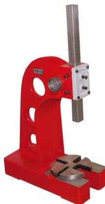
Die Holzmann DOP3000 Dornpresse ist ideal zum Einpressen von Lagern, Buchsen und anderen Fügearbeiten. Das hochwertige Graugussgestell ermöglicht die Aufbringung extrem hoher Presskräfte. Die Hebelkraftübertragung erfolgt durch eine großverzahnte Zahnrad-Zahnstangen-Kombination.
