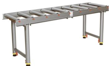
Die Holzmann RB9L Rollbahn ist eine robuste und höhenverstellbare Rollbahn mit 9 Rollen, ideal für den Einsatz in Lagerhallen, Werkstätten und anderen Betriebsbereichen. Die Rollbahn ist höhenverstellbar von 640-1100mm und kann bis zu 200kg belastet werden.
