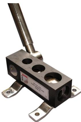
Die Holzmann RAM43 Rohrausklinkmaschine ist ein professionelles Werkzeug zum Ausklinken von Rohren. Der 910mm lange Abzugshebel mit Exzenterübersetzung ermöglicht das Ausklinken von Rohren bis 3mm Wandstärke. Die Maschine ist speziell geeignet für Gas-, Edelstahl-, NE- und Dampfrohre und kann für das Ausklinken der Schweißlinie für T- oder Doppeleckverbindungen verwendet werden. Die horizontale und vertikale Anwendungsmöglichkeit bietet Flexibilität bei der Verwendung.
