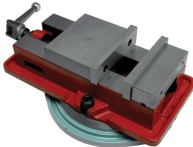
Der Holzmann IF160 Industrie Frässchraubstock Drehteller ist ein hochwertiges Werkzeug für die Metallverarbeitung. Die Backenbreite beträgt 160 mm, die Backenhöhe 45 mm und die maximale Backenöffnung 160 mm. Der Schraubstock ist in einer Achse schwenkbar.
