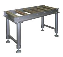
Die Holzmann RB6 Rollbahn ist eine robuste und höhenverstellbare Rollbahn mit 6 Rollen. Sie ist ideal für den Einsatz in Lager- und Produktionsbereichen. Die Rollbahn ist höhenverstellbar von 600-1000mm und hat eine Breite von 365mm. Das Gewicht beträgt 31kg und die Verpackungsmaße betragen 1030x120x475mm.
