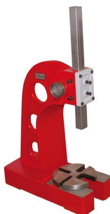
Die Holzmann DOP2000 Dornpresse ist ideal zum Einpressen von Lagern, Buchsen und anderen Fügearbeiten. Das hochwertige Graugussgestell ermöglicht die Aufbringung extrem hoher Presskräfte. Die Hebelkraftübertragung erfolgt durch eine großverzahnte Zahnrad-Zahnstangen-Kombination. Eine Universalgrundplatte ist ebenfalls vorhanden.
