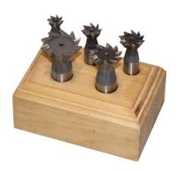
Der Holzmann SSF5 Schwalbenschwanzfräser ist ein vielseitiges Werkzeug für verschiedene Anwendungen. Die folgenden Größen sind verfügbar:  $13x60^{\circ}$ ,  $16x60^{\circ}$ ,  $20x60^{\circ}$ ,  $25x60^{\circ}$  und  $32x60^{\circ}$ .
