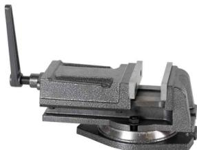
Der Holzmann I125 Maschinenschraubstock inkl. Drehplatte ist ein universell einstellbarer und in drei Achsen schwenkbarer Schraubstock. Die Stabilitätsverstrebung an der Schraubstockrückseite erhöht die Präzision. Der geschlossene Schraubstockkörper verhindert das Eindringen von Spänen. Der abnehmbare Steckhebel bietet weitere Flexibilität.
