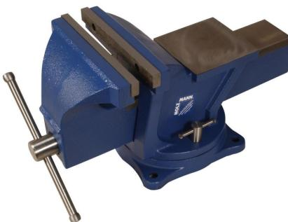
Der Holzmann WBS200N Werkbank Schraubstock inkl. Drehplatte ist ein vielseitiges Werkzeug für verschiedene Anwendungen. Die Werkbank verfügt über eine Ambossgröße von 120x120mm, eine Backenbreite von 200mm und eine Backenhöhe von 21mm. Die maximale Backenöffnung beträgt 175mm. Das Netto-Gewicht des Schraubstocks beträgt 26kg und das Material ist Gusseisen.
