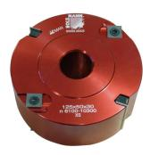
Der Holzmann FMK125 Falzmesserkopf ist zum Fälzen von Plattenwerkstoffen wie Sperrholz und Tischler-, Span- und Hartfaserplatten mit und ohne Kunststoffbeschichtung oder Furnier, verleimten Hölzern sowie Massivholz geeignet. Er ist für Tischfräsen mit Handvorschub konzipiert.
