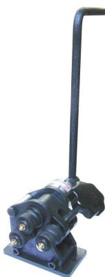
Die Holzmann RBM3 Mobile Rundbiegemaschine ist eine hochwertige Lösung für die Blechbearbeitung. Mit ihren Rundbiegerollen Ø 32 mm und dem langen Bedienhebel von 320 mm ermöglicht sie kräftegeschonendes Arbeiten. Die solide Grundplatte mit Bohrungen zum Befestigen auf dem Arbeitstisch und die Biegeradiuseinstellung mittels handlicher Einstellschraube bieten weitere Vorteile.
