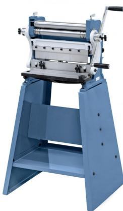
Die Bernardo 3 in 1 - 305 Universalmaschinen sind ideal geeignet für Karosseriebauer, Modellbauer und den Baustelleneinsatz. Sie ermöglichen das Rundbiegen, Abkanten und Schneiden von Materialien.
