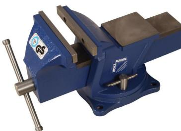
Die Holzmann WBS150N Werkbank Schraubstock ist ein vielseitiges Werkzeug für verschiedene Anwendungen. Die Werkbank ist aus Gusseisen gefertigt und bietet eine Ambossgröße von 90x90mm. Die Backenbreite beträgt 150mm und die Backenhöhe 19mm. Die maximale Backenöffnung beträgt 140mm.
