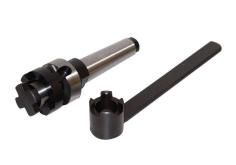
Die Holzmann KDMK432 Kombi Fräsaufnahme ist ideal für Walzenstirnfräser. Sie bietet eine Aufnahmedurchmesser von 32mm, Anzugsgewinde M16 und einen Aufnahmekonus MK4.
