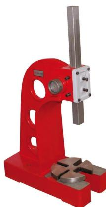
Die Holzmann DOP1000 Dornpresse ist ideal zum Einpressen von Lagern, Buchsen und anderen Fügearbeiten. Durch das hochwertige Graugussgestell können extrem hohe Presskräfte aufgebracht werden. Die Hebelkraftübertragung erfolgt durch eine großverzahnte Zahnrad-Zahnstangen-Kombination. Eine Universalgrundplatte ermöglicht eine flexible Verwendung.
