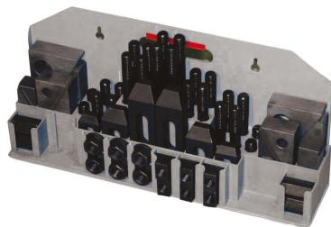
Das Holzmann 52TLG14 Spannwerkzeugsortiment umfasst 52 Teile und ist für eine T-Nutengröße von 14mm konzipiert. Es verfügt über ein Anzugsgewinde M12 und ist an einer Wand montierbar. Das Sortiment enthält 6 T-Nutsteine, 6 Flanschmuttern, 4 Überwurfmuttern, 6 Spannstempel, 6 Spannklemmen und 24 Stehbolzen in verschiedenen Längen.
