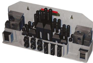
Das Holzmann 52TLG12 Spannwerkzeugsortiment umfasst 52 Teile und ist für eine T-Nutengröße von 12mm ausgelegt. Es enthält Anzugsgewinde M10 und ist an Wand montierbar. Das Sortiment beinhaltet 6 T-Nutsteine, 6 Flanschmuttern, 4 Überwurfmuttern, 6 Spannstempel, 6 Spannklemmen und 24 Stehbolzen in verschiedenen Längen.
