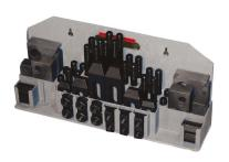
Das Holzmann 52TLG12 Spannwerkzeugsortiment umfasst 52 Teile und ist für eine T-Nutengröße von 12mm ausgelegt. Es enthält Anzugsgewinde M10 und ist an Wand montierbar. Das Sortiment beinhaltet 6 T-Nutsteine, 6 Flanschmuttern, 4 Überwurfmuttern, 6 Spannstempel, 6 Spannklemmen und 24 Stehbolzen in verschiedenen Längen.
