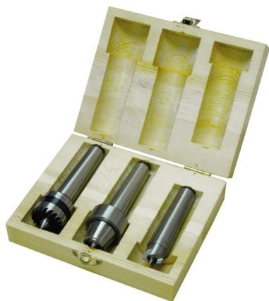
Das Holzmann MS3TLG Mitnehmer Set 3tlg / MK2 besteht aus herausnehmbaren Spitzen, teilweise gefedert, und enthält 2x Mitnehmer und 1x Rollkörper.
