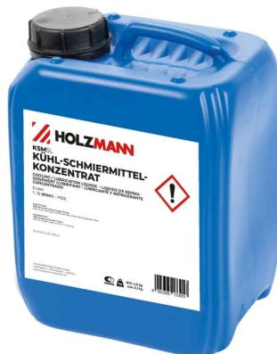
Das Holzmann KSM5L Kühl- Schmiermittelkonzentrat 1:30 5 Liter ist ein universelles Produkt zum Zerspanen und Schleifen. Es erzeugt hohe Oberflächengüte und hat eine optimierte Netz-, Kühl und Spülwirkung. Das Mittel ist 1:15 verdünnbar und hat eine gute Waschwirkung, die für saubere Maschinen sorgt. Es ist schaumarm, hat eine gute Filtrierbarkeit und geringe Vernebelung.
