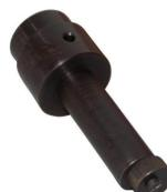
Das Holzmann ES30110 Exzenterspannsystem ist speziell zum Spannen von schweren, unwuchten Drechselteilen konzipiert. Es verfügt über ein M33 Gewinde und ist mit einer Länge von 110mm und einem Durchmesser von 30mm ausgestattet.
