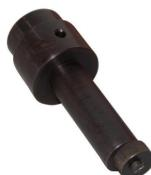
Das Holzmann ES25070 Exzenterspannsystem ist speziell zum Spannen von schweren, unwuchten Drechselteilen konzipiert. Es verfügt über ein M33 Gewinde und eine Länge von 70mm sowie einen Durchmesser von 25mm.
