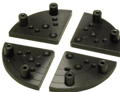
Die Holzmann DP95PS Planscheibe 125 ist eine hochwertige Planscheibe mit einem Durchmesser von 125 mm. Sie wird inklusive 16 gummibeschichteten Spannpratzen geliefert, bestehend aus 8 Spannpratzen mit einer Höhe von 18 mm und 8 Spannpratzen mit einer Höhe von 13 mm.
