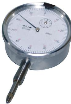
Die Holzmann AMU1 Analoge Messuhr ist ein präzises Messgerät. Es bietet eine Auflösung von 0,01mm und einen Hub von 0-10mm.
