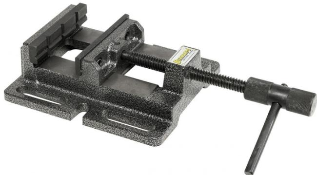
Der Bernardo Bohrmaschinenschraubstock BM 100 ist zum Spannen von Werkstücken auf Bohrmaschinen oder Bohrständern geeignet. Er zeichnet sich durch eine leichte Ausführung aus, sein Körper besteht aus Grauguss. Der offene Grundkörper macht ihn zum Durchbohren geeignet. Die Stahlbacken verfügen über Prismen.
