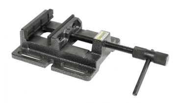
Der Bernardo Bohrmaschinenschraubstock BM 100 ist zum Spannen von Werkstücken auf Bohrmaschinen oder Bohrständern geeignet. Er zeichnet sich durch eine leichte Ausführung aus, sein Körper besteht aus Grauguss. Der offene Grundkörper macht ihn zum Durchbohren geeignet. Die Stahlbacken verfügen über Prismen.
