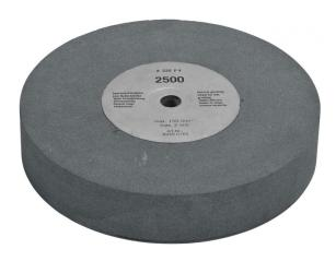
Die Bernardo Schleifscheibe Normalkorund  $250 \times 50 \times 32 \text{ mm}$  - K220 ist eine Schleifscheibe für Nass- und Trockenschleifer. Die Schleifscheibe hat einen Durchmesser von 250 mm, eine Breite von 50 mm und eine Bohrung von 32 mm. Die Körnung der Schleifscheibe beträgt 220.
