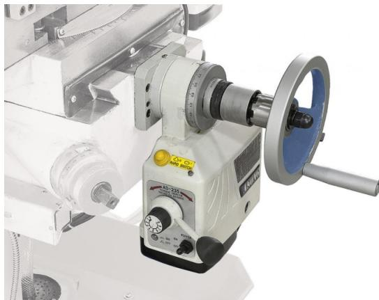
Der Vorschubapparat AL-500P-Y / 110 V ist ein Zubehör für Bohr- und Fräsmaschinen. Er ist verwendbar für die y-Achse.
