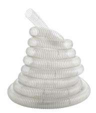
Der Bernardo Spiral-Absaugschlauch ist ein Zubehör für Absauganlagen. Er hat einen Durchmesser von 80 mm und eine Länge von 6 m. Der Schlauch ist transparent, flexibel und hat eine Stahlspirale.
