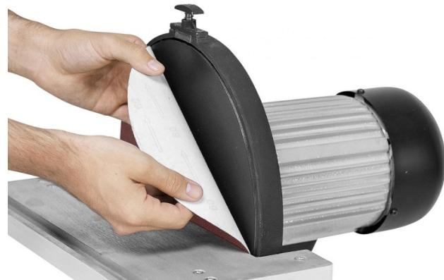
Die Klettauflagen sind auf der Rückseite selbstklebend und werden auf den Teller der Schleifmaschine geklebt. So kann ein schneller Wechsel zwischen unterschiedlichen Körnungen der Schleifmittel erfolgen.
