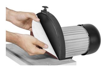
Die Klettauflagen sind auf der Rückseite selbstklebend und werden auf den Teller der Schleifmaschine geklebt. So kann ein schneller Wechsel zwischen unterschiedlichen Körnungen der Schleifmittel erfolgen.
