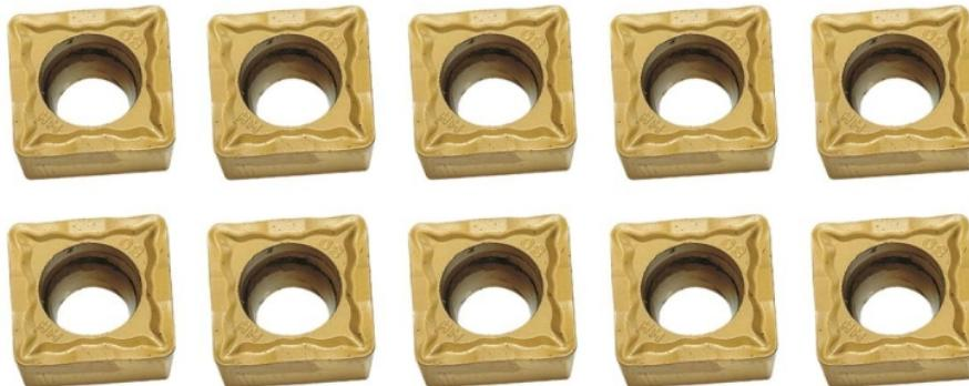
Der Satz HM-Wendeschneidplatten ist TiN-beschichtet und besteht aus 10 Stück. Er ist für verschiedene Bohrstangen geeignet, wie z.B. die Bohrstange 8 mm (Art. Nr. 46-1008), die Bohrstange 10 mm (Art. Nr. 46-1008 bzw. 46-1009) und die Bohrstange 12 mm (Art. Nr. 46-1008 bzw. 46-1009).
