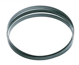
Das Bernardo Sägeband  $4540 \times 4 \times 0,65$  - 14 ZpZ ist ein hochwertiges Sägebänder für Vertikalbandsägen. Es ist aus HSS-Material gefertigt und bietet eine Abmessung von  $4540 \times 4 \times 0,65$  mm. Die Zähne pro Zoll betragen 14.
