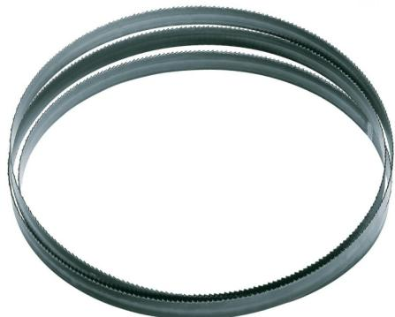
Das Bernardo Sägeband 4540 x 8 x 0,65 - 14 ZpZ ist ein Sägebänder für Vertikalbandsägen. Es hat eine Abmessung von 4540 x 8 x 0,65 mm und 14 Zähne pro Zoll. Das Material ist HSS.
