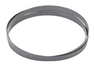
Das Bernardo Sägeband BiFlex  $1325 \times 13 \times 0.6$  - Vario 6/10 ZpZ ist ein hochwertiges Sägebänder für Metallbandsägen. Es ist aus BiFlex-Material gefertigt und bietet eine Abmessung von  $1325 \times 13 \times 0.6$  mm. Die Zähne pro Zoll sind variabel und betragen Vario 6/10 ZpZ.
