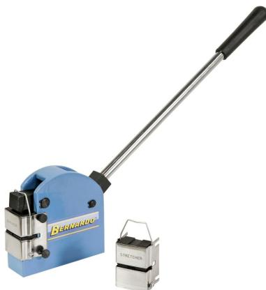
Das Bernardo SS 18 Stauch- und Streckgerät ist ein preiswertes Hobbygerät zum Stauchen und Strecken von Profilen, waagrechten Kurven, Fensterrahmen, Türkanten usw. Es ist zum Strecken und Stauchen von Blechen bis 1,2 mm Stahlblech, Aluminium bis 1,5 mm geeignet. Das Gerät ist inklusive je 1 Stk. Stauchwerkzeug und 1 Stk. Streckwerkzeug und kann universell im Werkstatt- und Baustellenbereich eingesetzt werden.
