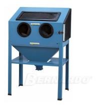
Die Bernardo SB 2 Sandstrahlkabinen sind ideal für verschiedene Anwendungen. Der Arbeitsraum bietet eine Abmessung von 840 x 550 x 370 mm. Die Kabinen sind für die Verwendung von Korngrößen zwischen 60 - 100 mesh geeignet. Der Luftverbrauch beträgt 550 l/min und der erforderliche Luftdruck liegt zwischen 4 - 8 bar.
