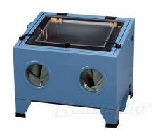
Die Bernardo SB 1 Sandstrahlkabinen sind ideal für verschiedene Anwendungen. Der Arbeitsraum bietet eine Abmessung von 580 x 480 x 300 mm. Die Kabinen sind für die Verwendung von Körnern mit einer Größe von 60 - 80 mesh geeignet. Der Luftverbrauch liegt zwischen 200 bis 350 l/min und der erforderliche Luftdruck beträgt 6 - 8 bar.
