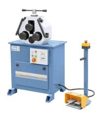
Die Bernardo RBM 30 Motorische Ringbiegemaschinen sind ideal für die Bearbeitung von Rohren und Profilen. Die Maschinen sind mit einer Motorleistung von 1,1 kW und einer Spannung von 400 V ausgestattet. Die Biegegeschwindigkeit beträgt 3 m/min.
