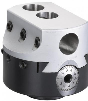
Der Bernardo Plan- und Ausdrehkopf mit einem Durchmesser von 100 mm ist ein präzises Werkzeug für verschiedene Anwendungen. Die Feinverstellung ermöglicht eine genaue Einstellung von 0,01 mm pro Teilstreich. Der Bohrstangendurchmesser beträgt 25 mm.
