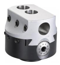
Der Bernardo Plan- und Ausdrehkopf mit einem Durchmesser von 100 mm ist ein präzises Werkzeug für verschiedene Anwendungen. Die Feinverstellung ermöglicht eine genaue Einstellung von 0,01 mm pro Teilstrich. Der Bohrstangendurchmesser beträgt 25 mm.
