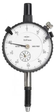
Die Bernardo Präzisions-Messuhr 10 x 0,01 mm ist eine hochgenaue Messuhr, die nach DIN 878 erstellt wurde. Sie ist staubgeschützt und eignet sich für verschiedene Messanwendungen.
